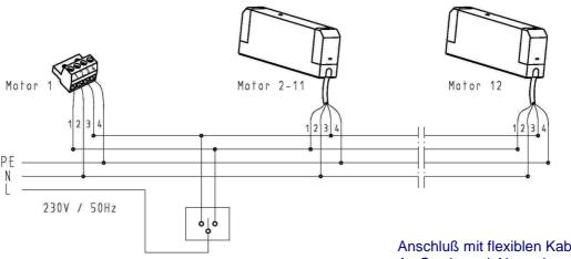
Anschluß mit flexiblen Kabel (4x0,75 mm²) An Stecker mit Numerierung 1-2-3-4
